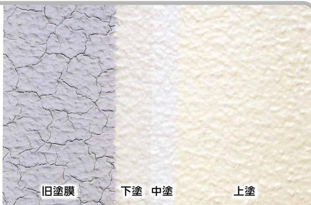
微弾性厚膜型塗膜を下塗に使用することで、ヘアークラックに追従します。
