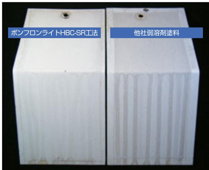
弱溶剤フッ素樹脂塗料「ボンフロンライト」に新たに低汚染機能を付与しました。フッ素樹脂塗料の特徴である高耐候性を損なうことなく、低汚染性も高耐候性に適応する持続性能を有しています。
